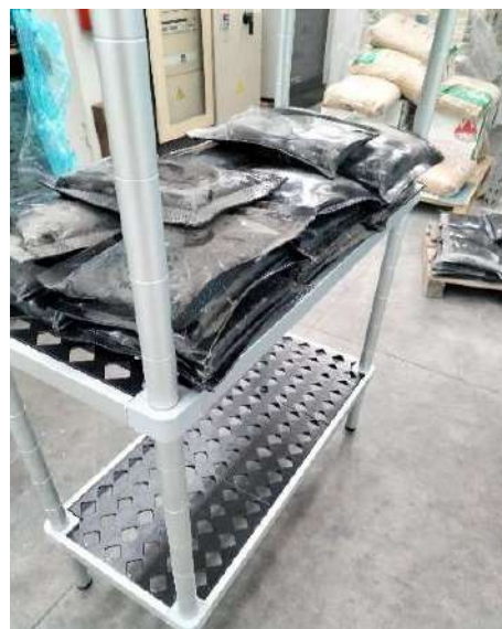
Prove di carico su ripiano della scaffalatura tecnica
