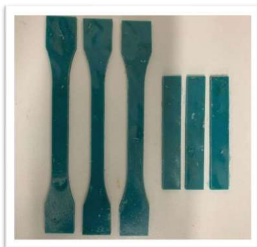
Provini stampati a compressione provenienti dal riciclo meccanico di mascherine chirurgiche
